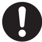
实心圆圈符号表示强制性操作，具体内容显示在圆圈内并附带文字说明。此示例表示一般的强制性事项。
