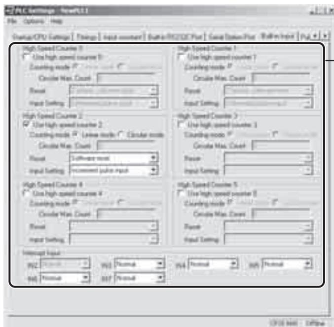
选择“Use high speed counter”（使用高速计数器）复选框以使用高速计数器
